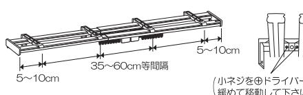
(3)プラケットをセットした本体を取付場所(木部)に木ネジで取り付けて下さい。
